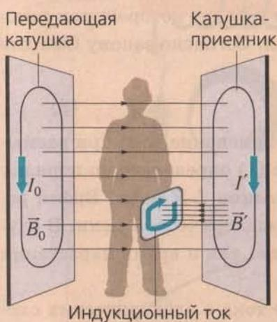
Детектор металла в аэропорте фиксирует поля индукционных токов в металлических предметах
